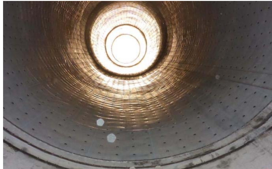
Auskleidung innen mit PFA-Folie
